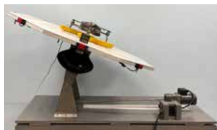
Рис. 10. Возможные состояния экспериментальной установки: а – крен 0^\circ ; б – крен 20^\circ ; в – крен 40^\circ
