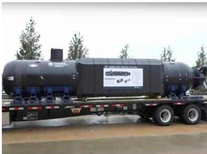
Среди множества экспонатов симпозиума Sea Air Space 2022 публике были представлены большие и малые АНПА. Университет Пенсильвании (Penn State University) на внешней экспозиции демонстрировал 54" Large Test Vehicle с необычной прямоугольной центральной секцией, содержащей экспериментальную систему энергообеспечения. На стенде компании L3Harris был показан 9" Iver4-900, задействованный в программе MEMUUV (Maritime Expeditionary Mine Countermeasures Unmanned Undersea Vehicle).
