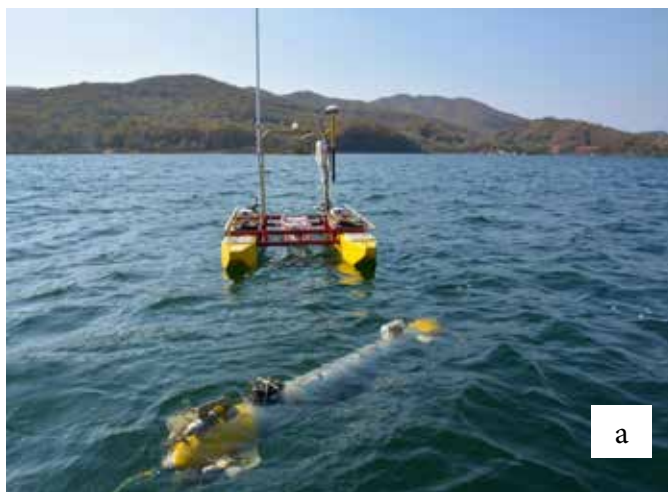
Рис. 2. АНПА перемещается над расположенным на морском дне трубопроводом и сопровождается обеспечивающим БЭК
