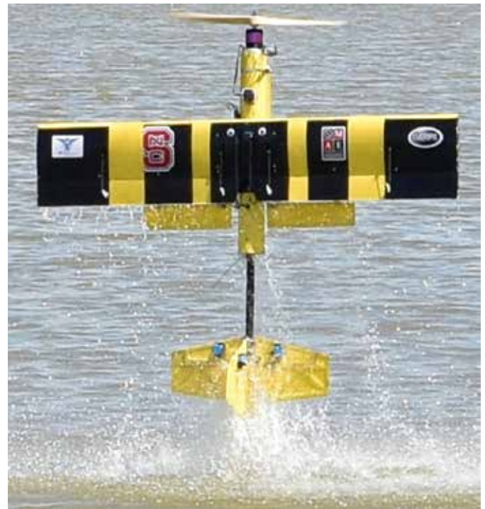
Рис. 6. Макет ГВПА из Университета Северной Каролины во время морских испытаний
