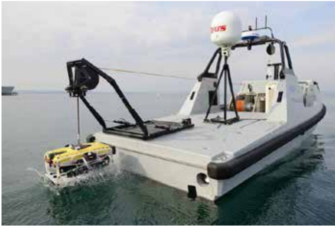
Рис. 1. Комплекс ТНПА и БЭК от компании Thales
