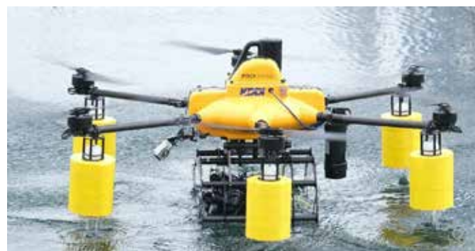
Рис. 4. Беспилотный летательный аппарат Sea-Air Integrated Drone опускается на воду перед запуском ТНПА FIFISH
