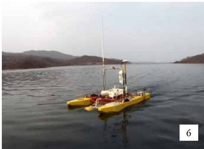
Рис. 3. Эпизоды испытаний морского автономного робототехнического комплекса, включающего АНПА и АНВА (а – аппараты в процессе совместной работы, б – АНВА доставляет АНПА к месту работы)
