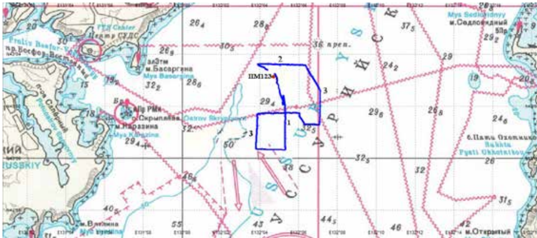
Рис. 5. Схема маневрирования НИС «Юрий Молоков» относительно приёмной системы ПМ123
