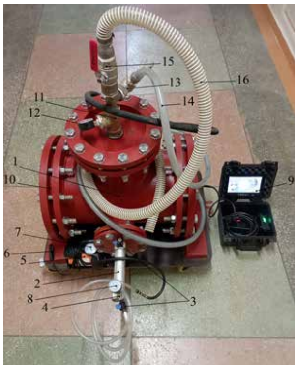
Рис. 2. Внешний вид установки для имитации гидростатического давления
