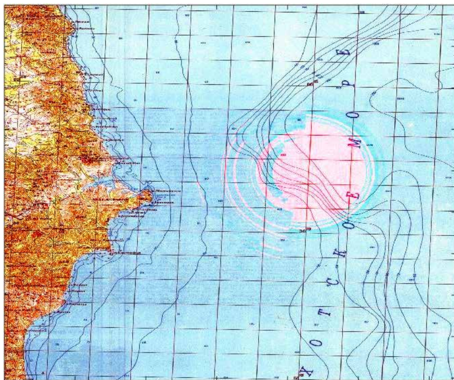
Рис. 4. Зона обзора одной ГАС, рассчитанная для АНПА с R_z=5 м, в районе с размерами 7–10 км со сложным рельефом дна. Видна зональная структура с большим провалом в зоне обнаружения
