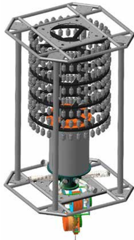
Рис. 1. Технический облик ГАС с приемной звукопрозрачной антенной цилиндрического типа с числом элементов 400 (10 по вертикали и 40 по окружности), расчетная зона обзора которых показана на рисунках 2–5
