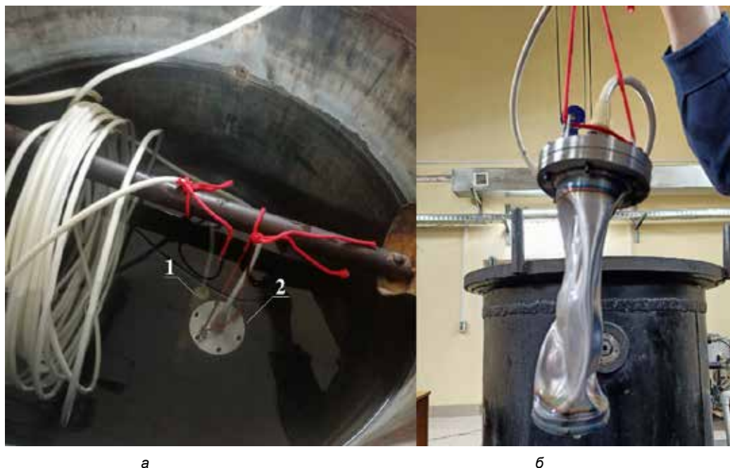
Рис. 2. Проведение эксперимента в КВД: а – закрепление гидрофона (1) и контейнера (2) в камере, б – состояние контейнера на момент его «схлопывания»
