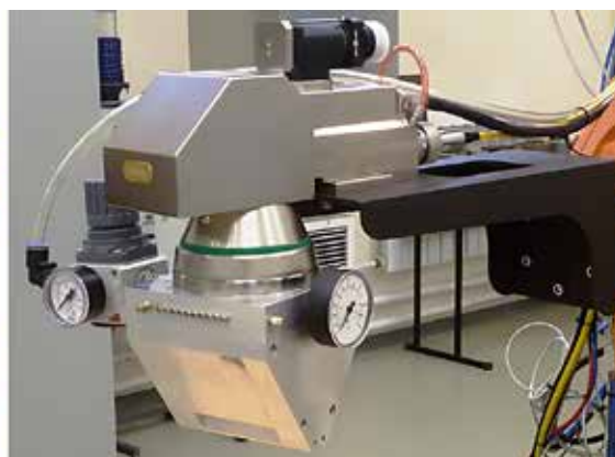
Рис. 5. Внешний вид щелевого сопла, установленного на сканирующую систему 2D «IPG Mid-PowerScanner»
