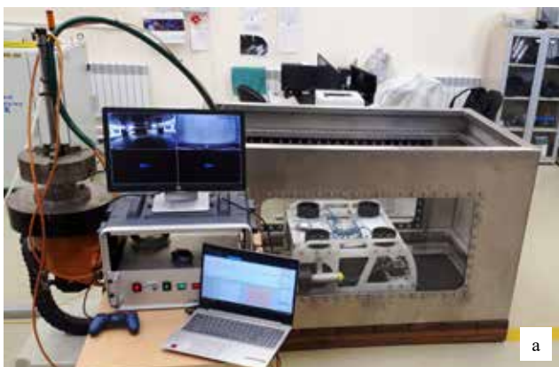
Рис. 19. Фрагменты испытаний ТНПА в режиме лазерной очистки экспериментальной пластины от биообрастателей: а – общий вид комплекса; б – ТНПА в процессе очистки пластины от биообрастателей, в – участок пластины после очистки
