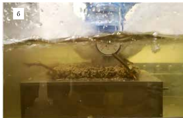
Рис. 7. Фрагменты экспериментальной очистки поверхностей от биообрастателей: а – общий вид установки лазерной очистки; б – очистка поверхности экспериментальной пластины от трубчатых многощетинковых морских червей в известковых домиках
