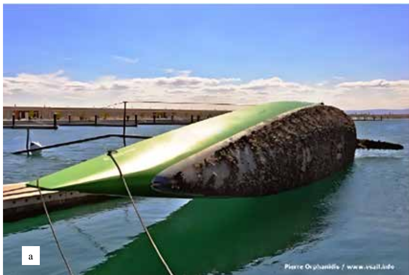
Рис. 1. Обрастание подводных поверхностей биоорганизмами: а – подводная часть судна, б – свая пристани (Черное море)
