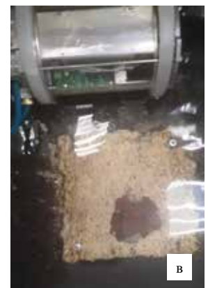
Рис. 19. Фрагменты испытаний ТНПА в режиме лазерной очистки экспериментальной пластины от биообрастателей: а – общий вид комплекса; б – ТНПА в процессе очистки пластины от биообрастателей, в – участок пластины после очистки
