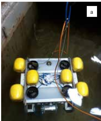
Рис. 18. Фрагменты испытаний ТНПА при движении под водой: а – в толще воды, б – на дне бассейна, в – на вертикальной стенке бассейна
