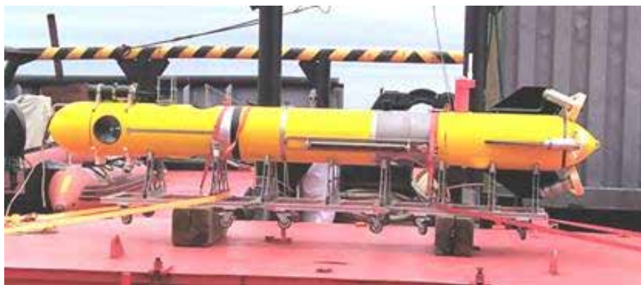
Рис. 4. Внешний вид АНПА «ММТ-300»
