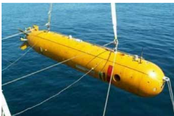
Рис. 2. АНПА Клавесин 1Р с +-образной схемой ПУ
