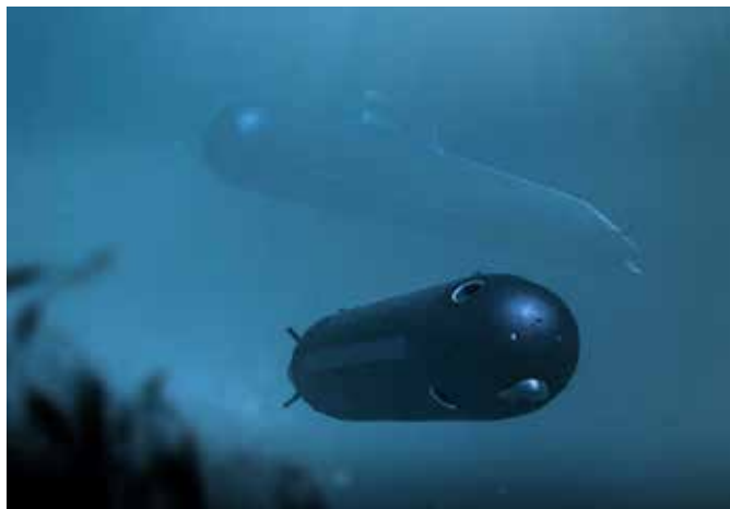
Рис. 1. АНПА LUUV компании Kockums с X-образной схемой ПУ
