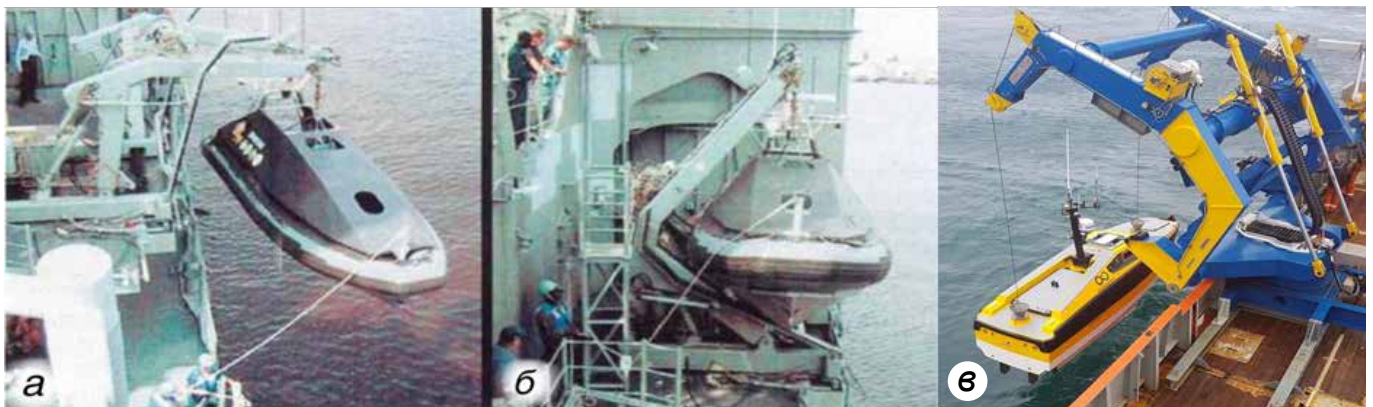
Рис. 1. Базирование БЭК на надводном корабле на автоматизированных шлюпбалках: а – подъем БЭК из воды; б – установка на штатное место; в – спуск БЭК на воду
