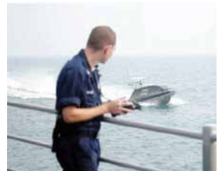
Рис. 13. Оператор подводит БЭК к судно-носителю, управляя им с выносного пульта
