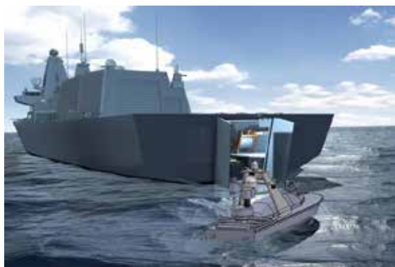
Рис. 7. Размещение БЭК в док-камере под вертолетной площадкой (СПУ в традиционном понимании здесь отсутствует)
