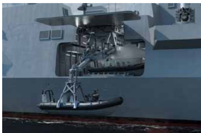
Рис. 5. СПУ БЭК в виде гидравлического подъемника со специальным ловителем
