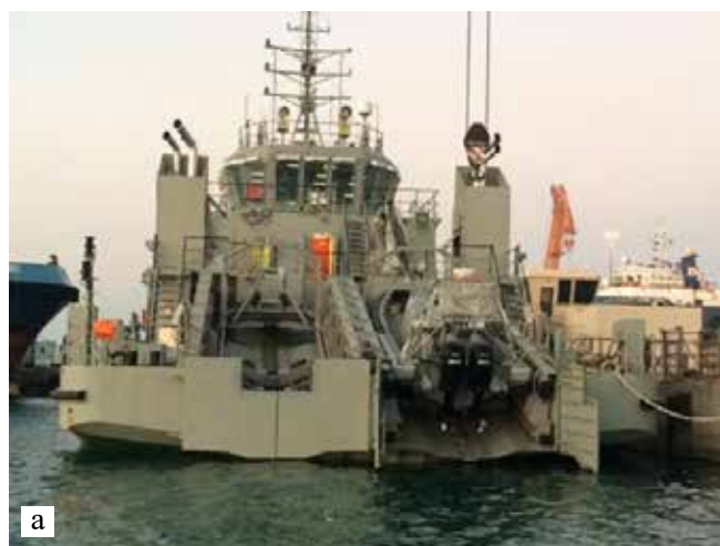
Рис. 4. Размещение СПУ БЭК в специальном ангаре надводного корабля: а, б – БЭК в ангаре; в – эпизод спуска на воду
