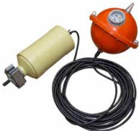
Рис. 1. Дрейфующий буй из состава макета сетевой подводной связи разработки АО «Концерн «ЦНИИ «Электроприбор»
