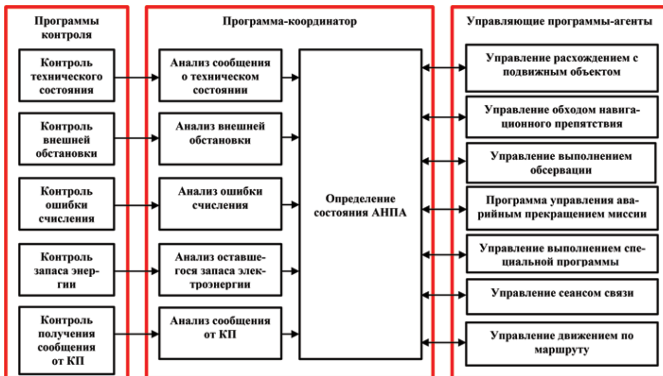
Рис. 2. Структура программного комплекса управления
