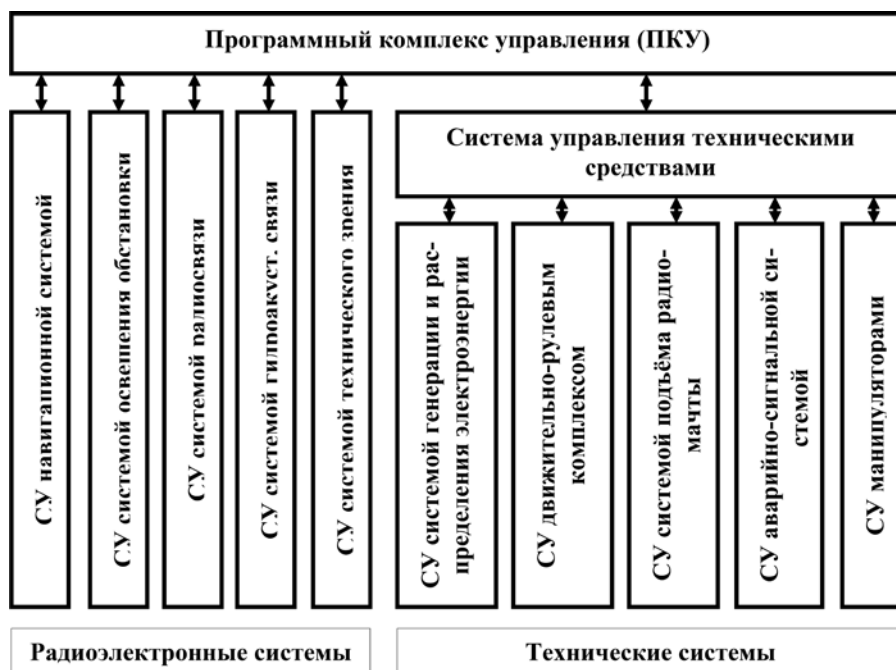
Рис. 1. Мультиагентная структура системы управления (СУ) АНПА
