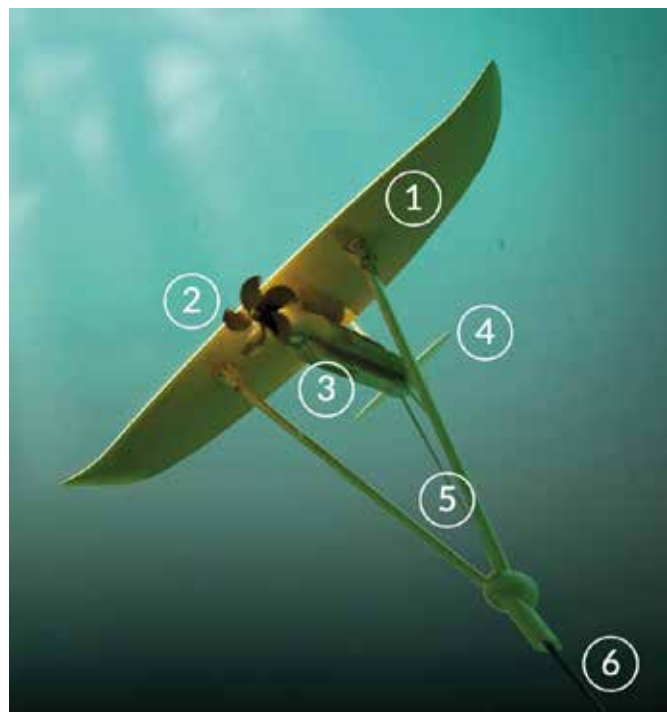
Рис. 12. Установка Minesto DG500. Цифрами обозначены: 1 – крыло, 2 – турбина, 3 – гондола, 4 – крыло руля, 5 – стойки, 6 – трос
