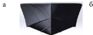
Рис. 2. Форма корпуса «классический глиссер»: а – вид сбоку; б – вид спереди; в – вид снизу
