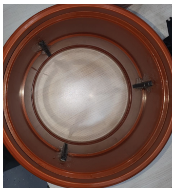
Рис. 10. Вклейка закладных и установка рамы в пропиленовый сантехнический раструб
