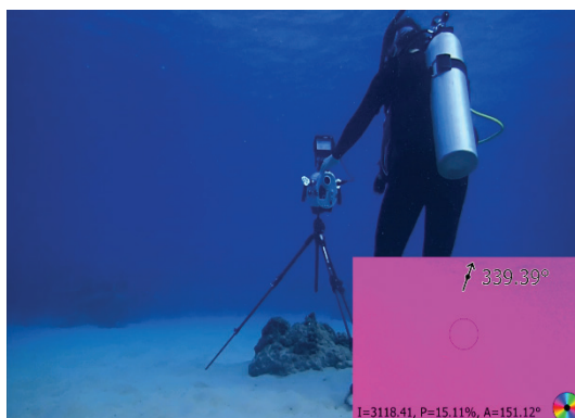
Рис. 4. Тестирование подводного метода навигации на основе поляризации, соединены поляризационная СТЗ с электронным компасом и датчиком наклона, измерения на основе подводной поляризации были проведены в различных местах по всему миру, при различных глубинах, условиях ветра и временах суток [2]
