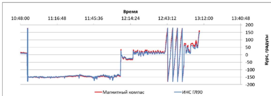
Рис. 12. Изменение курса по данным ИНС и магнитного компаса
